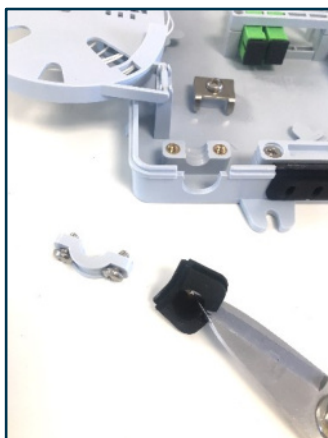
3. Retirar la brida de retención del cable y cortar la membrana de la goma de entrada de cable de alimentación.
