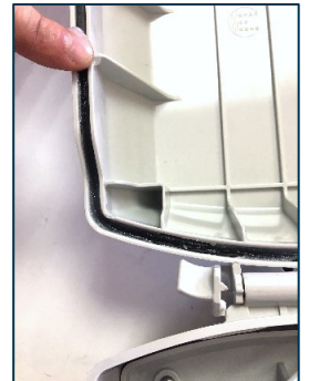
14. Aplicar vaselina sobre los obturadores de goma y la junta tórica de la tapa, esparcir con el dedo tal y como indica la imagen.
