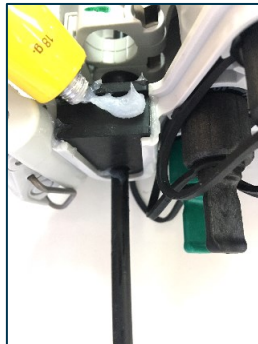
14. Aplicar vaselina sobre los obturadores de goma y la junta tórica de la tapa, esparcir con el dedo tal y como indica la imagen.
