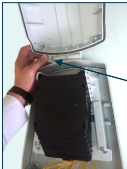
15. Para cerrar la tapa, pulsar el actuador tal como indica la figura.
