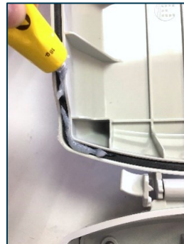
14. Aplicar vaselina sobre los obturadores de goma y la junta tórica de la tapa, esparcir con el dedo tal y como indica la imagen.
